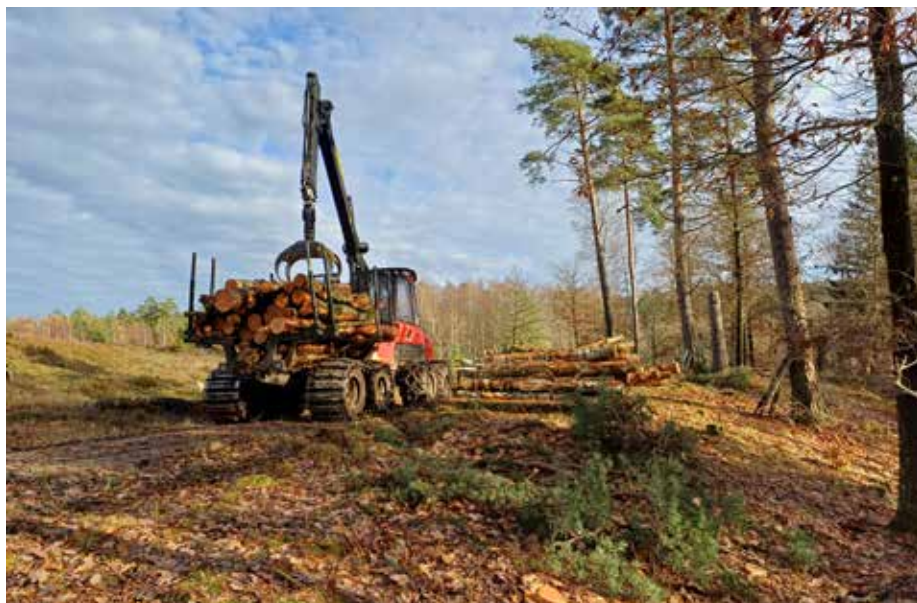
Utskotning av virke kunde ske med förhållandevis små körsador då marken var torr.
