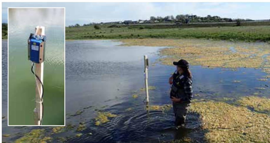
Figur 3. En av de 122 vattennivåmätarna som användes i projektet. Foton Lea D. Schneider
