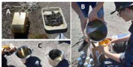
A: Ekmanhuggare; B: vi filtrerar vatten med ett planktonnät; C: metallvaror för att undvika kontaminering med plast. Foto: Antonia Liess.
